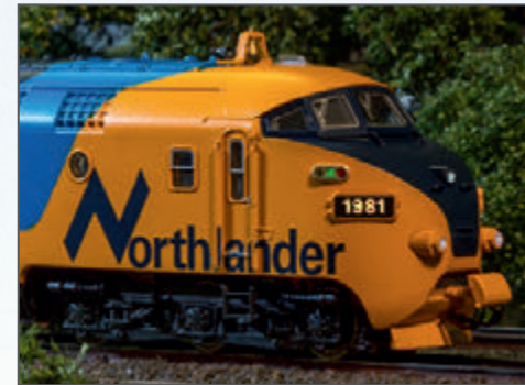
Classification Lights – également appelés feux de gabarit, ils donnent des informations sur le statut du train
