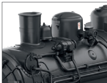
Turbo-dynamo pour l'éclairage électrique et cloche entre la cheminée et le dôme d'alimentation
