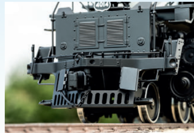
L'attelage frontal est astucieusement dissimulé dans le chasse-pierres derrière deux clapets
