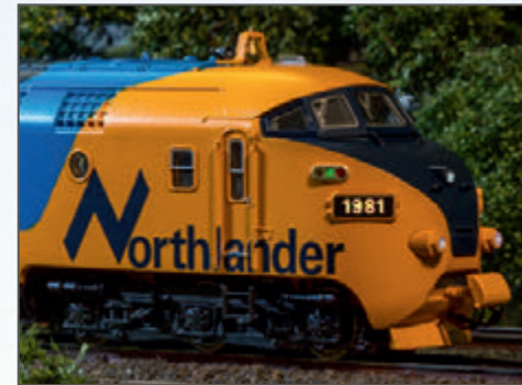
Claasification Lights - ook wel Begrenzingslicht genoemd, maken duidelijk welke status de trein heeft
