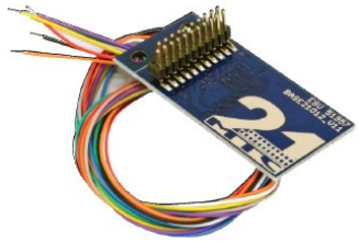
51957 adapterprint 21MTC met 8 versterkte uitgangen
