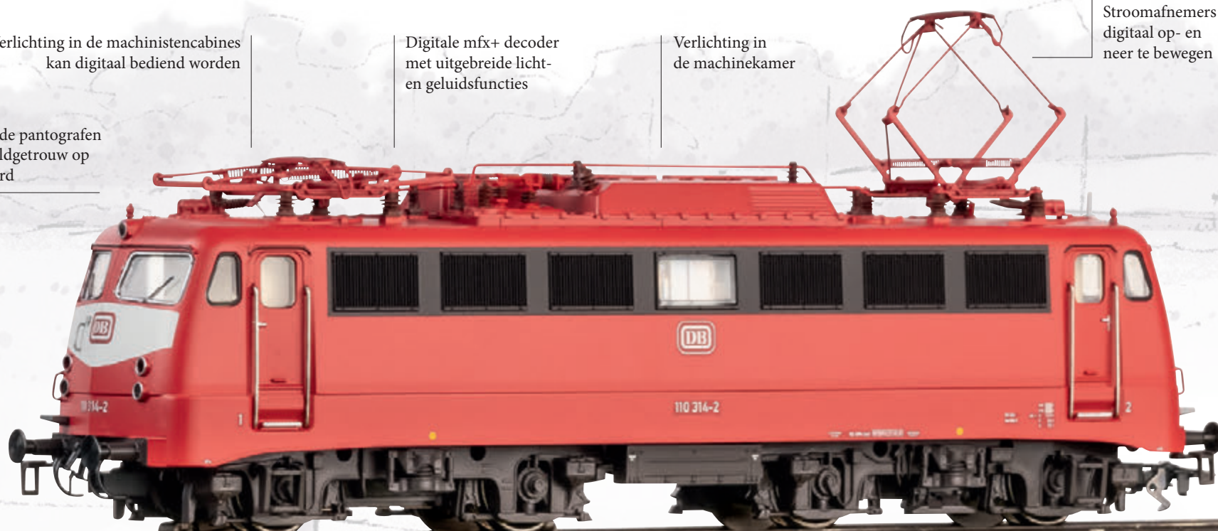
Bufferhoogte volgens NEM en met meeverende kortkoppelingen
